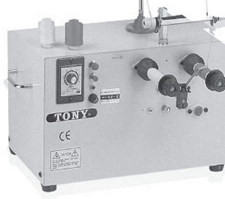
070025 Ripassatore TONY Mod. "H 02" a due coni, automatico con misurazione a tempo.
