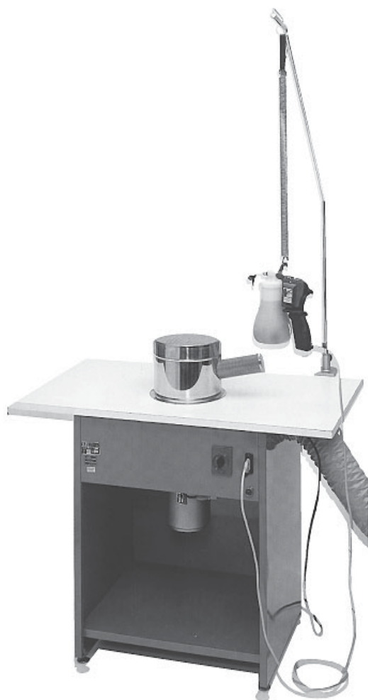
032235 Tavolo aspiratore DABO Mod. "MT/70" per la smacchiatura dei capi con elettropistola. A due bocche aspiranti, una circolare centrale per il corpo ed una cilindrica laterale per le maniche. Diametro bocca aspirazione centrale cm. 20.
