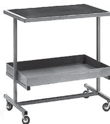
030354 Carrello trasporto semilavorati Mod. IM 200 cm 64x40x67. Piano di appoggio superiore ricoperto in gomma. Ruote Ø mm 80.
